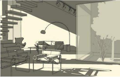
**Dibujo con estilógrafo:** el estilógrafo se emplea generalmente después de haber hecho el dibujo a lápiz, ya que esta técnica no permite el borrado ni la rectificación.
