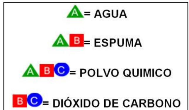
**Extintores de agua Clase (A):** los extintores Clase A contienen “agua” que actúa disminuyendo la temperatura y la reacción química del fuego. El agua está presurizada con un gas inerte. El agua sale por una manguera con un pico al final (para un chorro fino). Aplicaciones típicas: fuegos de madera, papel, cartón, algodón, plásticos, gomas, telas...
