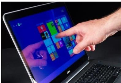
Una pantalla táctil es un tipo de pantalla que permite la entrada de datos y órdenes a la computadora presionando sobre ella con el dedo o empleando algún dispositivo apuntador. Es un periférico de entrada/salida. Touchscreen en inglés.
